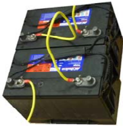
電源 (バッテリー) 鉛シールバッテリー 1 2 V , 2 0 A h × 2 台 大きさ 約 350 × 250 × 170
